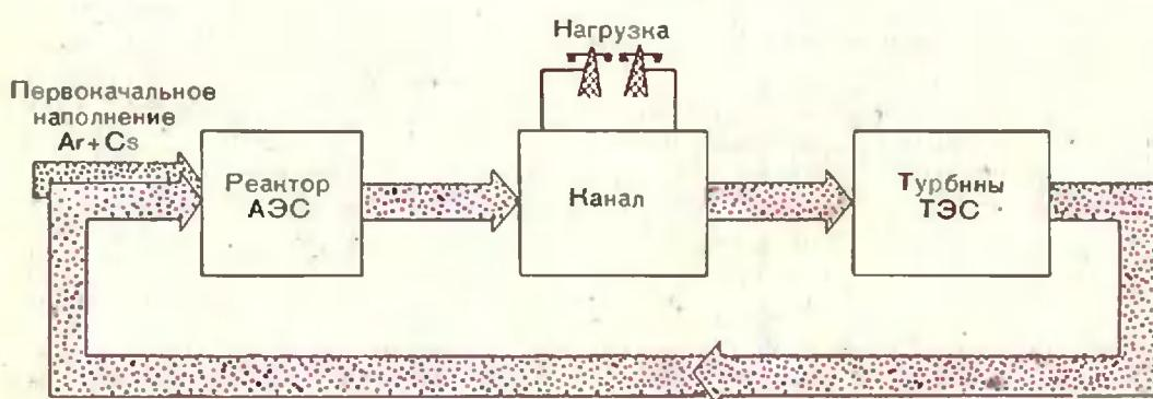
**МГД-генератор с закрытым циклом.**
