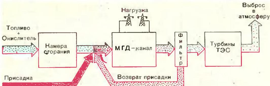
**МГД-генератор с открытым циклом.**
